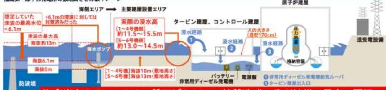
海食崖を20m～30m盤下げし10mの地盤造成こそが被災の最大の要因
